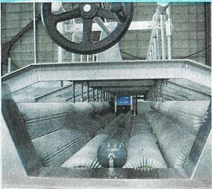
葉がついたままダイコンを洗浄できる機械。回転するブラシの中を進み、シャワー状の水が泥を落とす（エフ・イー提供）
