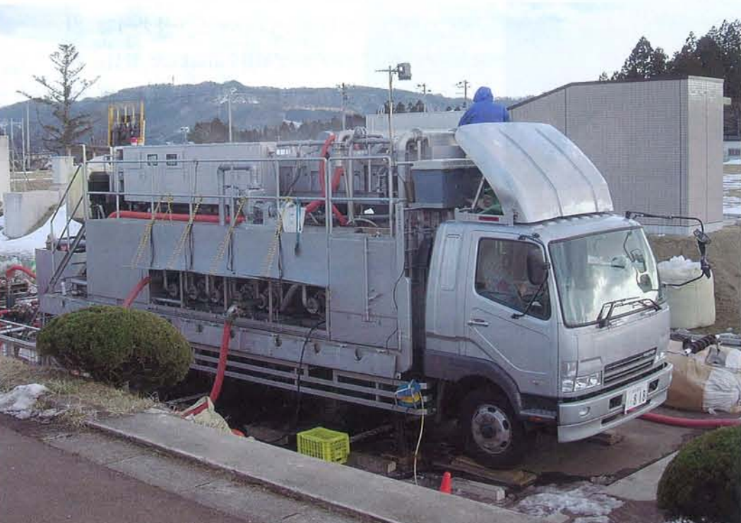
トラックに搭載された浄水施設のろ材洗浄システム。吸い上げられたろ材の砂や砂利が自動的にサイズ違いに分別され、強力な水の噴射によりもみ洗いされる。従来全て入れ替えられていたろ材だが、リサイクルされることによりコストも半分ほどですむようになった。
