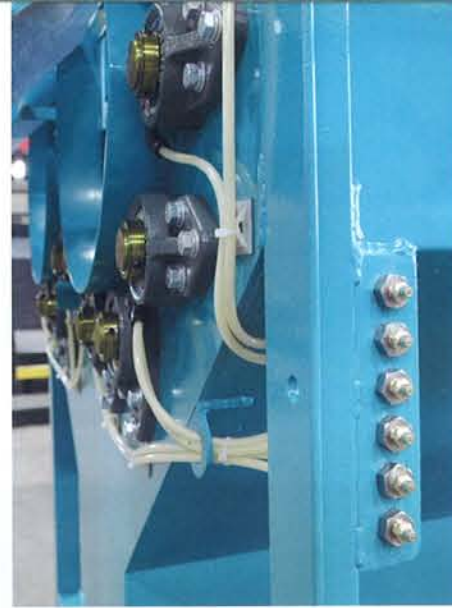
右下の6個の部品はグリス注入口。普段カバーが付いた左上のローラーの軸部分に、カバーが付いたままでも手軽にメンテナンスができる仕組みだ。細部に至る気配りが壊れにくい機械を生む。
