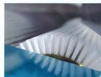
ブラシの束が無数に植毛されたローラー。水を含むと一束ごとに毛細管現象が働き、表面に水膜ができる。ブラシではなく水が直接大根と触れるため、葉を痛めることはない。ここが特許の所以である。
