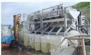
トラックに搭載された浄水施設のろ材洗浄システム。吸い上げられたろ材の砂や砂利が自動的にサイズ違いに分別され、強力な水の噴射によりもみ洗いされる。従来全て入れ替えられていたろ材だが、リサイクルされることによりコストも半分ほどですむようになった。
