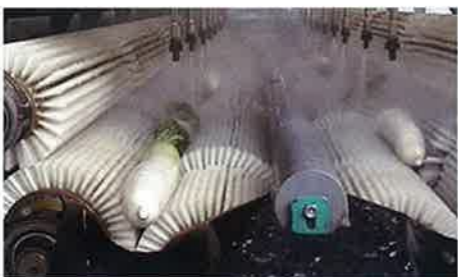
投入口に入れるだけで大根がきれいに洗浄される。1台150万円~700万円程度。現在は海外との取引も増えている。
