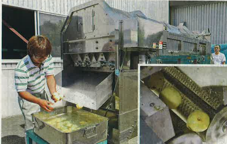
根菜類自動皮むき装置。右下白枠内は装置内部。刃のない回転ドラムでジャガイモの皮をむく (伊丹恒撮影)
