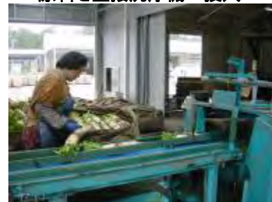
原料を直接洗浄機へ投入
