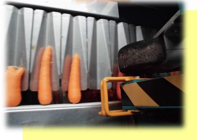
ソフトドラムと、専用トレイでしっかりと人参をホールドしてカットします。本体はSS製ですが、原料に触れる要部はSUS製を採用しています。
