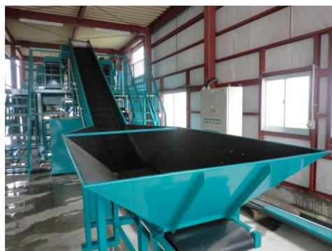
原料供給コンベアを用いて、一定量を安定的に供給するコンベアです。
